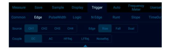
Figure 6-11 Edge Trigger Setting Menu
