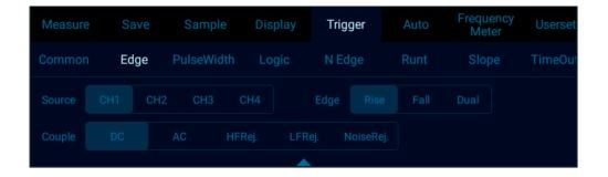
Figure 6-11 Edge Trigger Setting Menu
